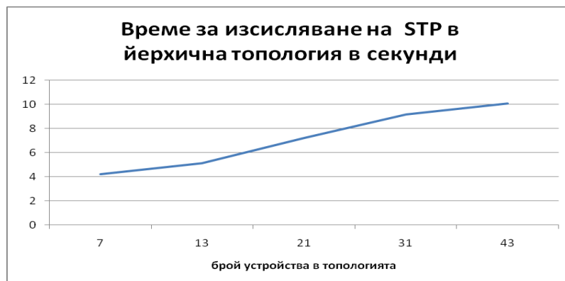
Фиг.1 Време за настройване на STP при йерархична топология при различен брой устройства
