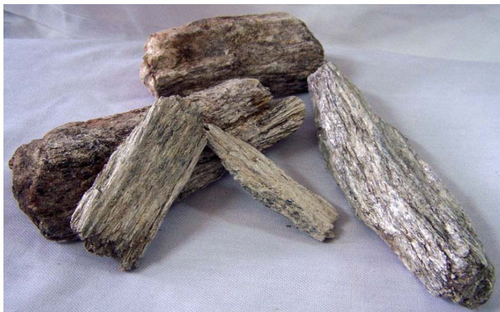
Фиг. 9 Азбест от нах. Талково поле (образците се съхраняват в Лаборатория „Гемология” – БФ, НБУ
