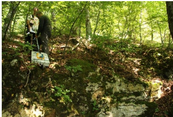
Фиг. 20 Георадарно изследване над пещера „Живата вода“
